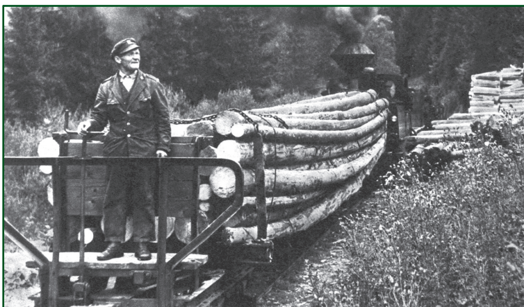
48. Posun s opleňovým vozňom naloženým dlhým drevom. Pri brzde Michal Buncko
